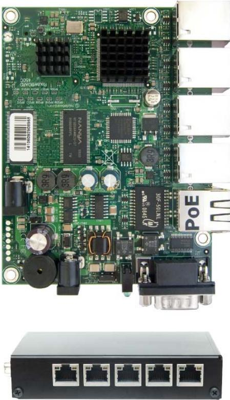
El RB450G es un router Gigabit de 5 puertos Ethernet. Comparada con la RB450, la RB450G no solamente contiene capacidad de velocidad Gigabit, también tiene una memoria RAM de 256Mb, así como un rápido CPU y una entrada para una tarjeta microSD para guardar los archivos de almacenamiento.
